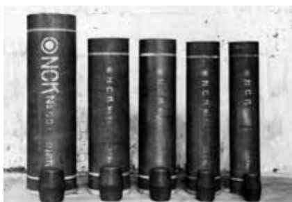
1927年 人造黒鉛電極製造に成功 日本初となる6インチから12インチの人造黒鉛電極の製造に成功
