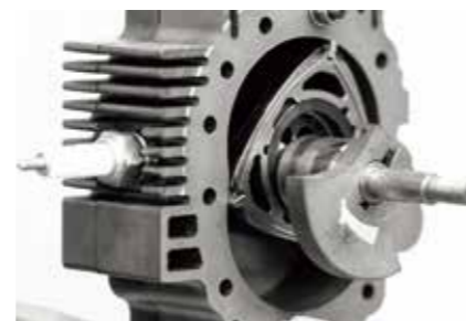
1966年 アベックスシールの工業化 アルミ-炭素複合材を開発し、ロータリーエンジンハウジング内の「悪魔の爪痕」と呼ばれた摩耗を克服
