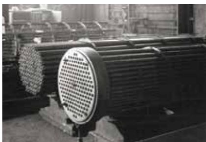
1949年 不浸透黒鉛の工業化 化学プラント用不浸透黒鉛「レスボン」の製造を開始し、国産第1号となる塩酸吸収塔が稼働
